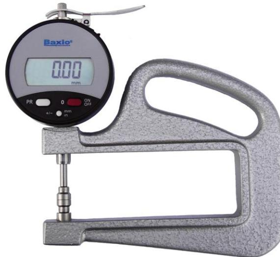
Medidor de espesores digital con resolución centesimal. Pantalla de grandes dígitos funciones de puesta a cero, conversión mm / pulgadas, entrada del valor de inicio, cambio del sentido de medida, y salida de datos USB. Escote 100mm. Palpadores de serie 8mm de diámetro. Bajo pedido, pueden fabricarse de la medida que se desee.
